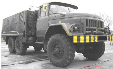
Рисунок 1 – Аеродромний багатоцільовий кондиціонер АМК-24/56-131
