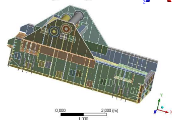
Рисунок 9 – Варианты усиления базового варианта корпуса выбивной машины
