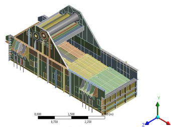
Рисунок 8 – Номинальная структура конструкции выбивной виброударной машины
