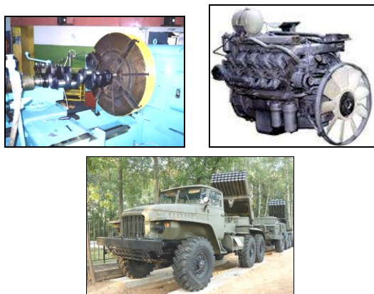
Рис. 5 – Дискретно зміцнений колінчастий вал двигуна для встановлення на шасі установки "Град"
