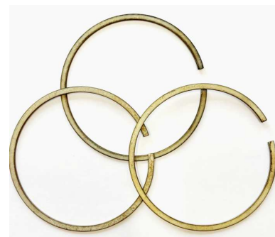
Рисунок 2 – Поршні кільця з алюмінієвого сплаву Д16 з МДО-покриттям
