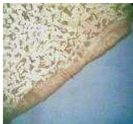
Рисунок 22 – Мікроструктура поперечного шліфа зразка сталі 45 в зоні розряду; \times 100 ; електрод – сталь 08Х18Н10Т
