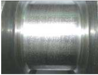
Рисунок 20 – Зовнішній вигляд шийки колінчастого валу після ДЕЗ до полірування
