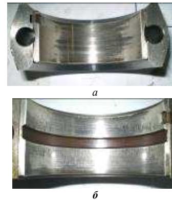
Рисунок 50 – Вигляд поверхонь шатунного та корінного сталєалюмінієвих вкладишів дизеля 4ЧН 12/14 після 80 годин роботи: а – шатунний вкладиш; б – корінний вкладиш
