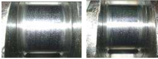
Рисунок 49 – Вигляд поверхонь корінної та шатунної шийок дизеля 4ЧН 12/14 після 80 годин роботи а – корінна шийка; б – шатунна шийка
