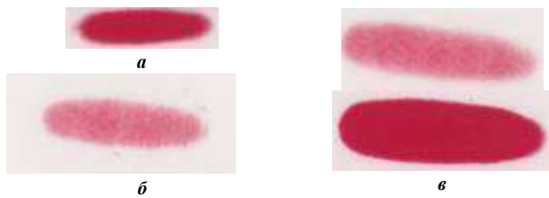
Рисунок 14 – Контактні відбитки у спряженні кулькового поршня з біговою доріжкою радіуса 34,25 мм при дії різних притискових сил: a – 1000 Н; б – 5000 Н; в – 6000 Н
