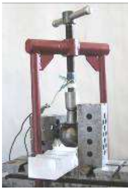
Рисунок 13 – Загальний вигляд експериментальної установки для дослідження контактної взаємодії кулькового поршня радіальної ГОП із біговими доріжками різної форми
