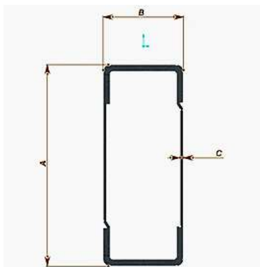
Рисунок 4 – Форма та базові розміри поперечного перерізу балок (розміри А, В, С наведено в табл. 2)
