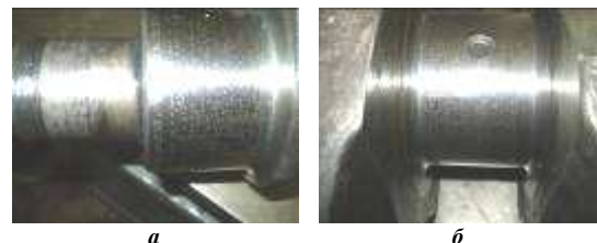
Рисунок 43 – Загальний вид робочої поверхні корінної та шатунної шийки сталевого колінчастого валу двигуна 4ЧН 12/14 після зміцнення:
