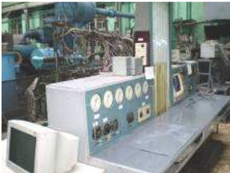
Рисунок 47 – Загальний вигляд експериментального стенду на базі дизельного двигуна 4ЧН 12/14
