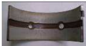
Рисунок 45 – Шатунний та корінний вкладиші робоча поверхня яких зміцнена методом мікро дугового оксидування: a – шатунний вкладиш; б – корінний вкладиш
