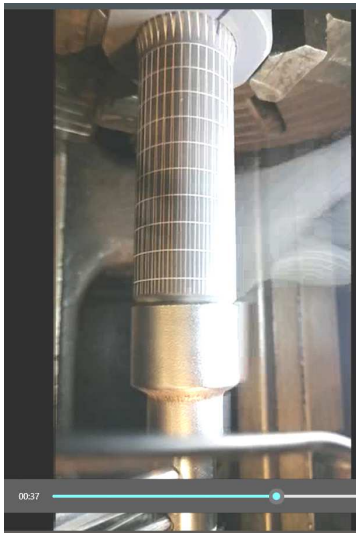
Рисунок 12 – Вигляд ліній валу на момент руйнування
