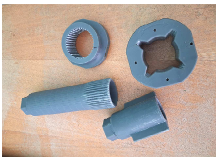
Рисунок 5 – Елементи моделі, виконані за технологією 3D друку
