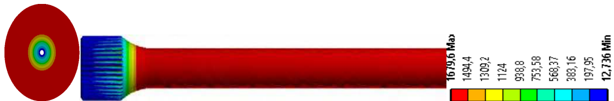
Рисунок 3 – Розподіл еквівалентних напружень за Мізесом, МПа, у ТВ [3]
