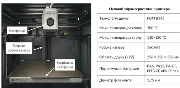
Рисунок 2 – Обладнання та технологічні особливості виготовлення сегментів шнека методом FDM-друку
