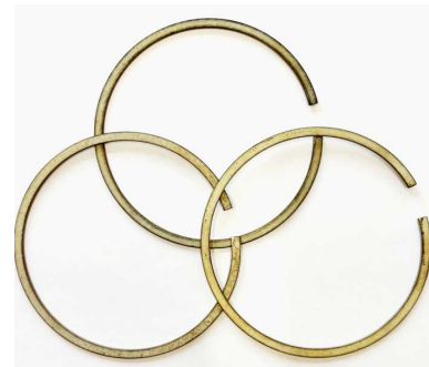
Рисунок 2 – Поршні кільця з алюмінієвого сплаву Д16 з МДО-покривом
