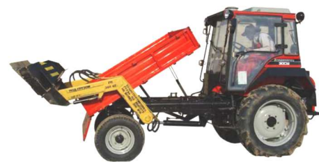
Рисунок 2 – Фронтальний навантажувач на ТСШ
