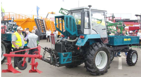
Рисунок 4 – Тракторне самохідне шасі в агрегативанні з навісним двокорпусним плугом
