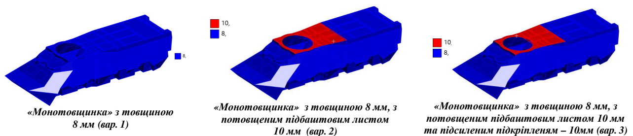
Рисунок 16 – Геометрична модель тестового варіанту БТР-3Е для трьох варіантів геометрії
