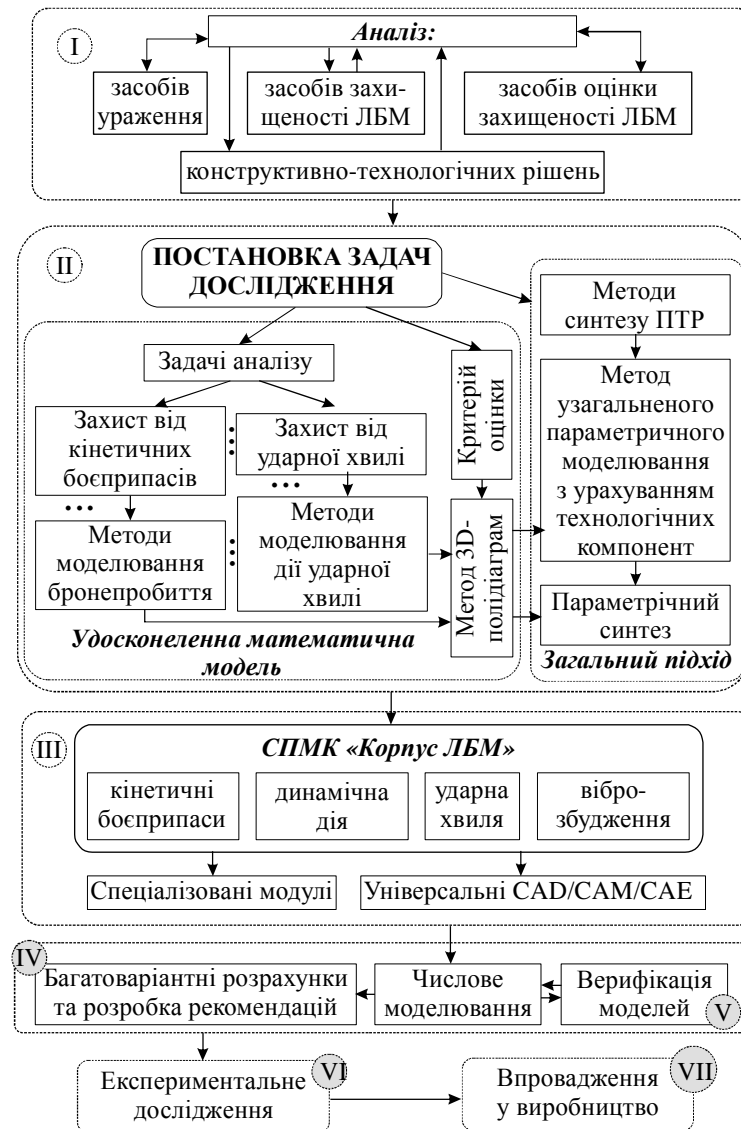
Рисунок 3 – Структура досліджень процесів і станів у бронекорпусах легкоброньованих машин у аспекті захищеності за допомогою спеціалізованого програмно-модельного комплексу (СПМК) «Корпус ЛБМ»
