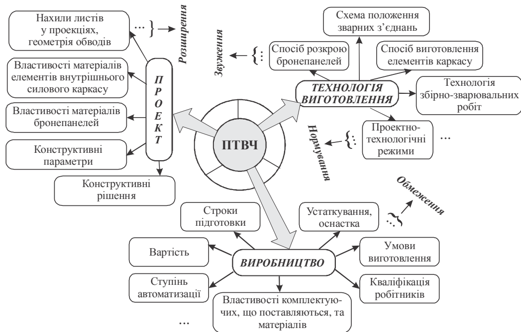
Рисунок 5 – Формування урахуванням проектно-технологічно-виробничих чинників, що визначають ТТХ ЛБМ (на прикладі захищеності бронекорпусів)
