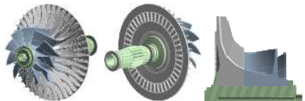
Рисунок 3 – До питання дослідження нагнітача повітря при варіюванні натягу крильчатки на вал: геометрична модель (матеріал крильчатки – алюміній, матеріал вала – сталь)
