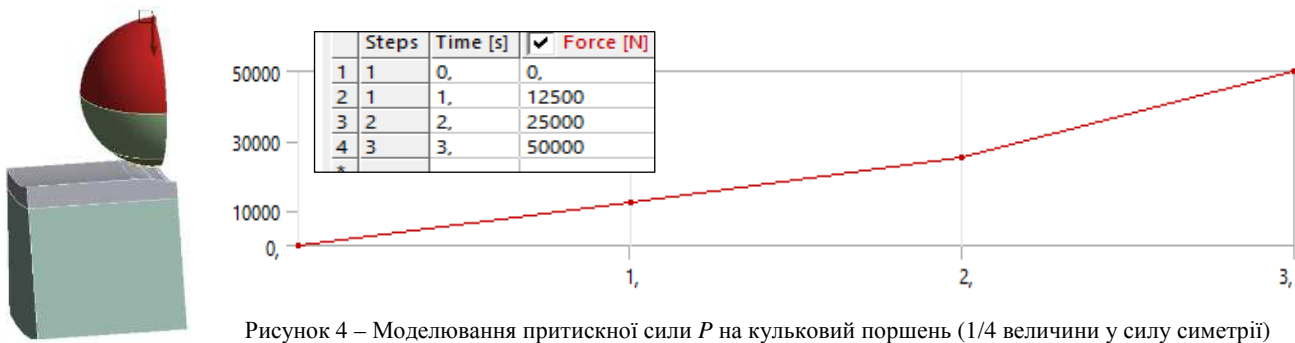
Рисунок 4 – Моделювання притискної сили P на кульковий поршень (1/4 величини у силу симетрії)
