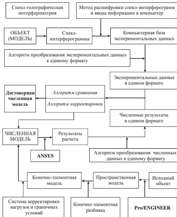
Рисунок 5 – Взаимодействие модулей созданного САПР на базе метода конечных элементов и спекл-голографической интерферометрии
