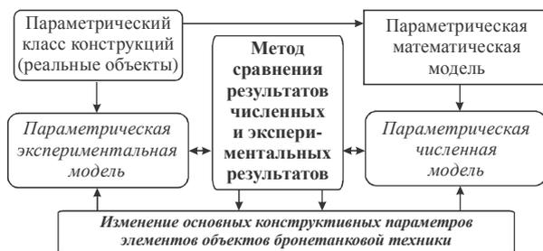
Рисунок 2 – Структурная схема системы автоматизированного расчетно-экспериментального исследования
