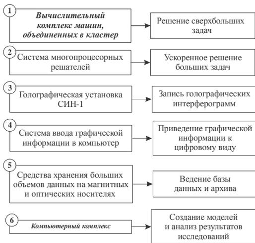
Рисунок 7 – Состав и функции элементов аппаратного обеспечения программно-аппаратного комплекса
