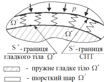
Рис. 6 – Модель шорсткого складнопрофільного пружного тіла
