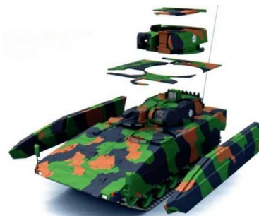
Рис. 2 – Приклад установки додаткового бронювання на БМП "Пума"
